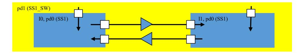
set\_isolation pd0\_iso\_in -domain pd0 -applies\_to inputs -isolation\_supply\_set SS1 \
